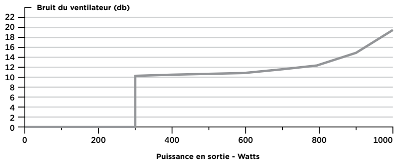
Courbe de bruit du ventilateur de l'alimentation CORSAIR AX1000
