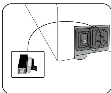
Tähän laitteeseen on asennettu sulake, joka sijaitsee laitteen takana pääkytkimen ja pistokkeen välissä. Sulakkeen vaihtaminen:
