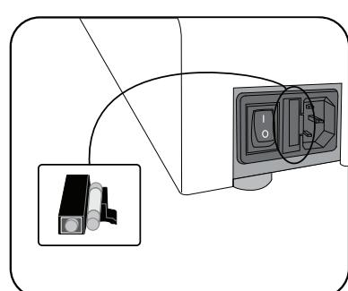
Questa macchina è dotata di un fusibile situato sul retro tra l'interruttore principale e la presa di corrente. Per sostituire il fusibile:
