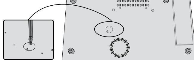
Naprava je opremljena s stikalom za toplotno ponovno nastavitev. Stikalo se bo vklopilo, ko se bo naprava preveč segrela. To se med normalno rabo ne bi smelo zgoditi. Za ponovno nastavitev stikala:
