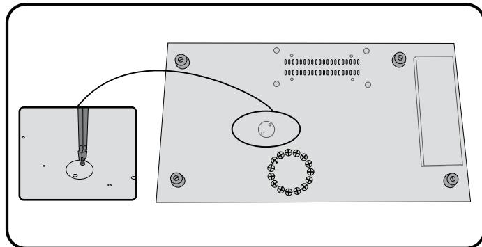
Urządzenie posiada wyłącznik termiczny. Powoduje on wyłączanie urządzenia, jeśli zbytnio się rozgrzeje. Nie powinno się to zdarzyć podczas normalnego użytkowania. Aby ponownie uruchomić urządzenie:
