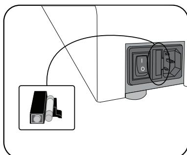
In dit apparaat is een zekering ingebouwd. Deze bevindt zich tussen de aan/uit-schakelaar en de elektriciteitsaansluiting aan de achterkant van het apparaat. Vervang de zekering als volgt:
