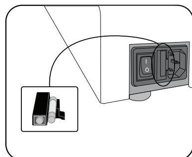
Maszyna posiada bezpiecznik umieszczony pomiędzy głównym przełącznikiem a gniazdem ścennym z tyłu maszyny. Aby wymienić bezpiecznik:
