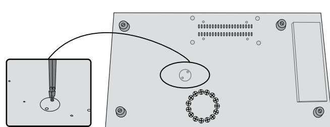
Zariadenie je vybavené spínačom tepelného resetovania. Spínač sa aktivuje pri nadmernom prehriatí zariadenia. Za normálneho používania by k tomu nemalo dôjsť. Resetovanie spínača:
