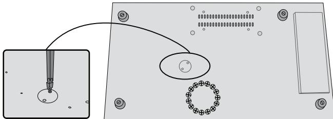
La máquina incorpora un interruptor de reinicio térmico. El interruptor se activará cuando la máquina esté demasiado caliente. Este estado no debería darse durante un uso normal. Para restablecer el interruptor:
