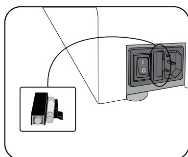
Tento přístroj je vybaven pojistikou, která se nachází na zadní straně přístroje mezi vypínačem a zásuvkou napájení na zdi. Výměna pojistiky:
