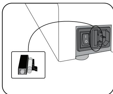
Naprava je opremljena z varovalko, ki je nameščena med glavnim stikalom in stensko vtičnico na hrbtni strani naprave. Za zamenjavo varovalke:
