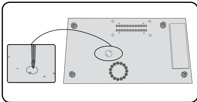
Přístroj se dodává s tepelným vypínačem. Vypínač se aktivuje, když se přístroj příliš zahřeje. Při běžném používání by k tomu nemělo dojít. Reset vypínače:
