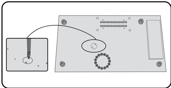
Makinede bir termal sıfırlama anahtarı bulunmaktadır. Bu anahtar, makine çok ısındığında devreye girer. Bu durum, normal kullanımda meydana gelmemelidir. Anahtarı sıfırlamak için:
