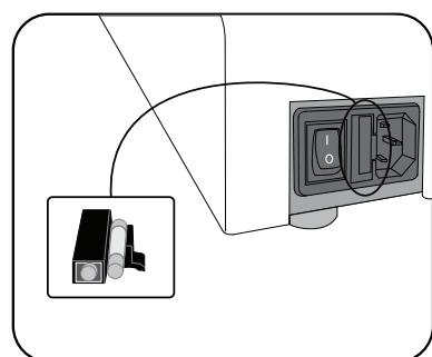
Denne maskinen er utstyrt med en sikring som er plassert mellom hovedbryteren og stikkontakten bak på maskinen. Skifte sikringen:
