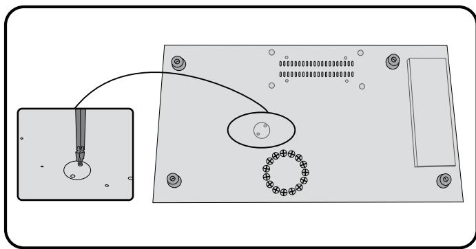
Устройство оборудовано переключателем теплового сброса. Этот переключатель активируется в тот момент, когда устройство становится слишком горячим. При нормальном использовании не должно возникать такого состояния. Для сброса переключателя выполните следующие действия.
