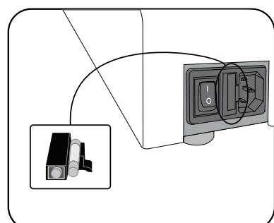
Este aparelho integra um fusível, situado entre o interruptor principal e a tomada de parede na parte de trás do aparelho.
