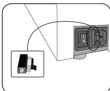
Ova mašina je opremljena osiguračem koji je smešten između glavne sklopke i zidne utičnice na poleđini mašine. Da zamenite osigurač:
