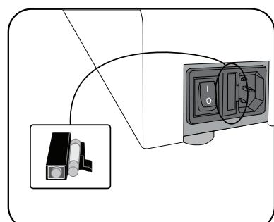
Данное устройство оборудовано предохранителем, расположенным между выключателем электропитания и настенной розеткой в задней части устройства. Для замены предохранителя выполните следующие действия.
