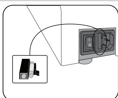
Ez a gép biztosítékkal rendelkezik, amely a főkapcsoló és a fali aljzat között található, a gép hátsó részén. A biztosíték cseréje:
