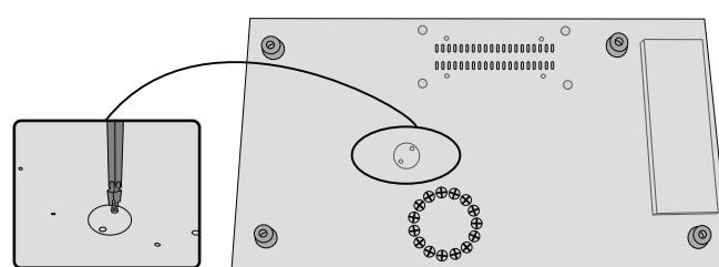
Stroj ima sklopku za ponovno postavljanje topline. Sklopka će se aktivirati kad stroj postane prevruć. To se ne bi trebalo dogoditi tijekom uobičajene uporabe. Za ponovno postavljanje sklopke:
