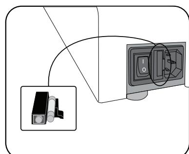
Acest aparat este prevăzut cu o siguranță, situată între comutatorul principal și priza de perete, în partea posterioară a aparatului. Pentru a înlocui siguranța:
