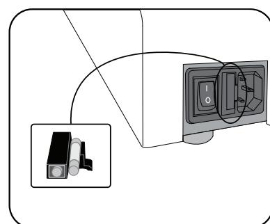
Dieses Gerät ist mit einer Sicherung ausgestattet; sie befindet sich zwischen dem Hauptschalter und der Wandsteckdose an der Geräterückseite. So wird die Sicherung ausgewechselt:
