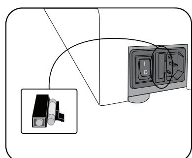
تتمتع الماكينة بفتحة بديل لإعادة ضبط تيار الهواء الساخن. يتم تنشيط مفتاح التبديل عندما تصبح الآلة ساخنة جدًا. ويجب ألا تحدث هذه الحالة أبدًا.
