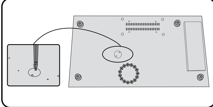
Das Gerät verfügt über einen Überhitzungsschutzschalter, der sich aktiviert, wenn das Gerät zu heiß wird. Dies sollte bei normalem Betrieb nicht geschehen. So wird der Schalter zurückgesetzt:
