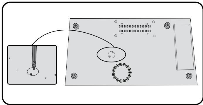
A készülék hőkapcsolóval is el van látva. A kapcsoló akkor lép működésbe, amikor a készülék túlhevül. Ilyen állapot normál használat során nem következik be. A kapcsoló visszaállítása:
