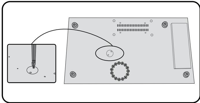
Maskinen är utrustad med en brytare för återställning av temperaturen. Brytaren aktiveras när maskinen blir för varm. Det är ovanligt att detta inträffar vid normal användning. Så här återställer du brytaren:
