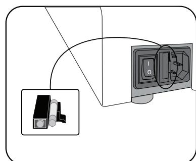
Denne maskine er udstyret med en sikring, som er placeret mellem hovedafbryderen og vægudtaget bag på enheden. Sådan udskiftes sikringen:
