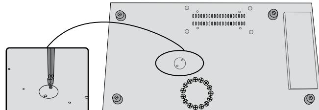
O aparelho integra um interruptor de reposição térmica. O interruptor será activado quando o aparelho atingir uma temperatura excessiva. Esta situação não deve ocorrer durante a utilização normal. Para repor o interruptor:
