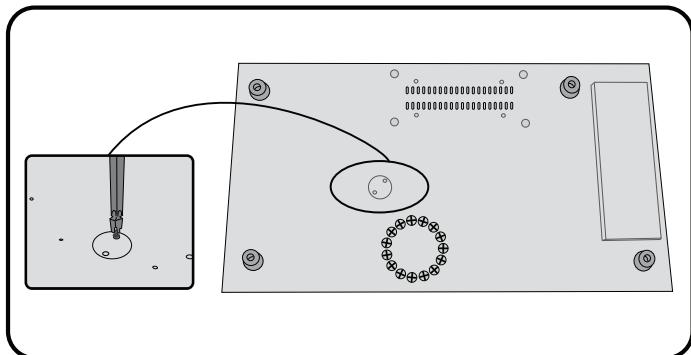
Aparatul este dotat cu un comutator de reconfigurare termică. Comutatorul se va activa atunci când aparatul se încălzește prea mult. Această situație nu ar trebui să se producă pe durata utilizării normale. Pentru a reconfigura comutatorul:
