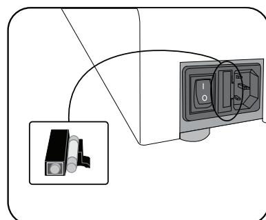
Esta máquina está equipada con un fusible, que se encuentra entre el interruptor principal y la toma de pared en la parte posterior de la máquina. Para sustituir el fusible:
