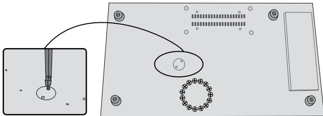
La machine est équipée d'un bouton de réinitialisation thermique. Ce dernier est activé dès que la machine atteint une température excessive. Ceci ne devrait pas se produire dans des conditions normales d'utilisation. Pour réinitialiser le bouton :
