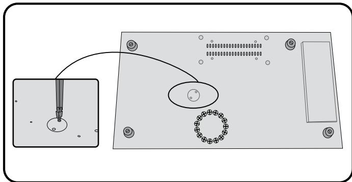
Tässä laitteessa on lämpökatkaisun palautuskytkin. Lämpökatkaisu toimii, kun laite kuumenee liikaa. Niin ei pitäisi käydä normaalina käytön aikana. Kytimen palautus:
