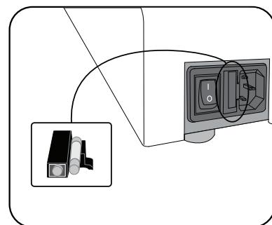
Cette machine est équipée d'un fusible situé à l'arrière, entre l'interrupteur principal et la prise murale. Pour remplacer le fusible:
