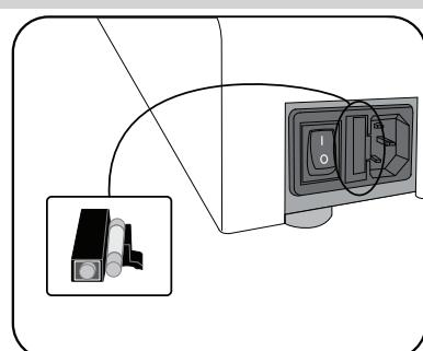
Тази машина е оборудвана с предпазител, разположен между главния прекъсвач и контакта в задната част на машината. За да смените предпазителя:
