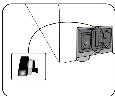
Den här maskinen är utrustad med en propp som hittas mellan huvudbrytaren och eluttaget på maskinens baksida. Så här byter du säkringen:
