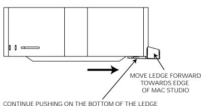
CONTINUE PUSHING ON THE BOTTOM OF THE LEDGE WHILE PUSHING THE TOP PIECES AGAINST THE OUTSIDE OF THE MAC STUDIO
