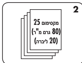
2. נקבו את הגליונות בקבוצות קטנות, כדי לא להעמיס מדי את המכשיר או את המשתמש. התאימו את מדריך הקצה, במקרה הצורך.
