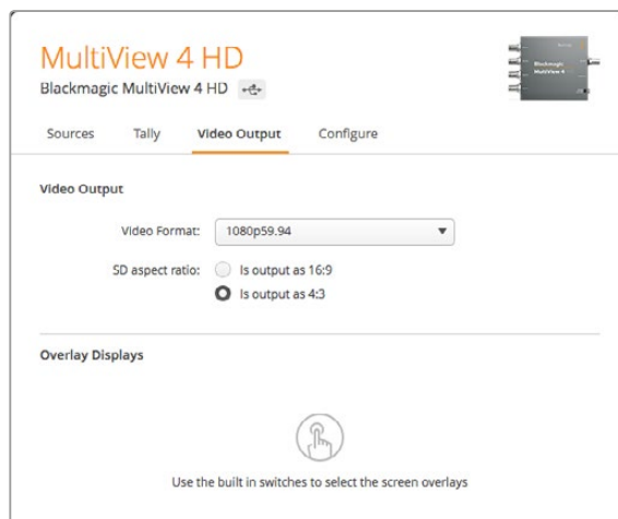
Options SD Aspect Ratio du menu Video Output de l'utilitaire MultiView Setup.
