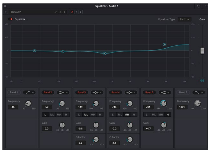
图为六频段参量均衡器，它可应用到每个轨道
